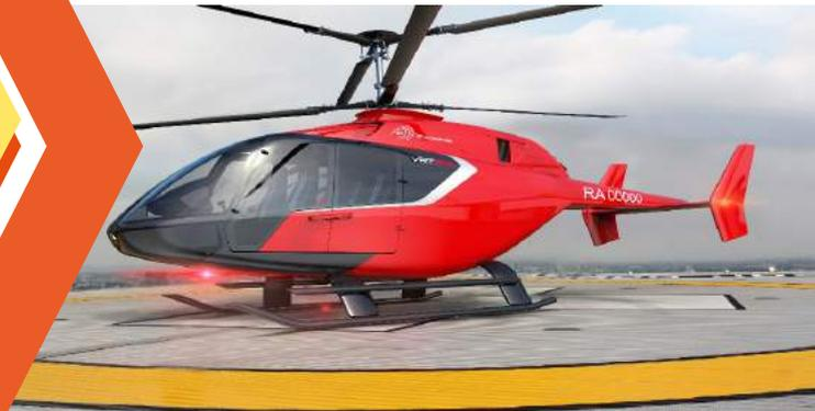
Серийное производство легкого цельнокомпозитного вертолета соосной схемы VRT-500
